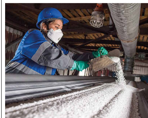
Отбор проб для контроля качества на производстве карбамида
