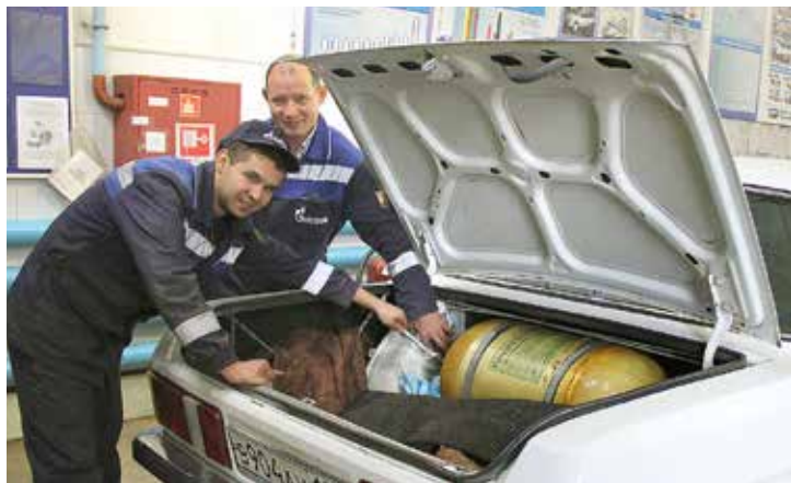
После установки газобаллонного оборудования
