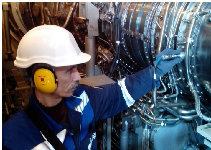
В. Акимов. Вибродиагностика двигателя АЛ-31СТ на КС-18А «Москово»
